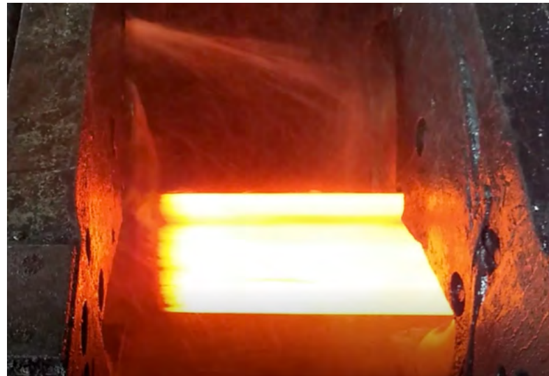
Figura 3. Imagen del tubo durante el proceso de calibrado en su paso entre dos cajas de calibrado.
