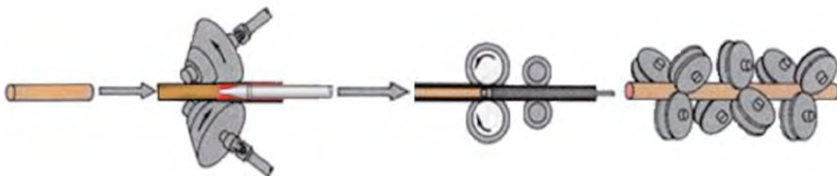
Figura 1. Las 3 fases del proceso de fabricación de tubos sin soldadura: perforación, estirado en banco de empuje, y calibrado.
