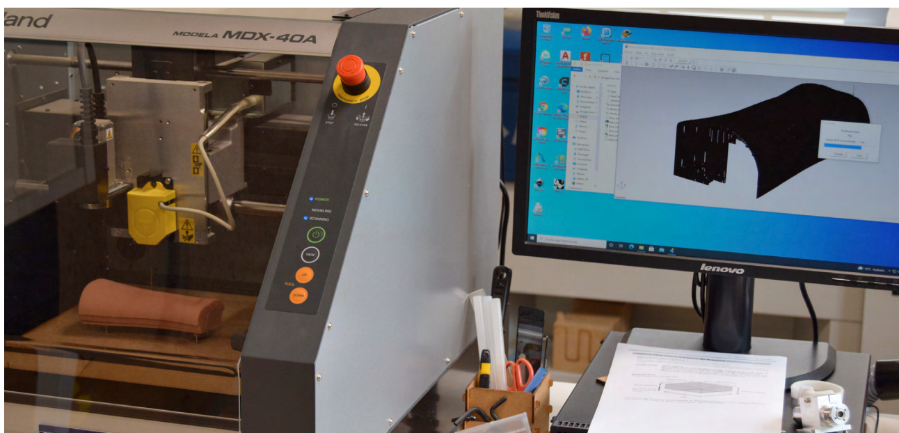
Escaneo 3D de la pieza con la Roland MDX40
